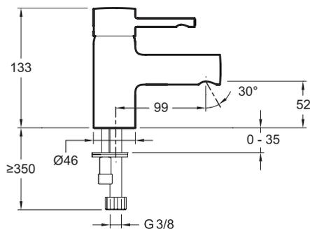
Спецификация продукта: Однорычажный смеситель для раковины без донного клапана. E98297. Коллекция: CUFF. ВЕС: 1,1 кг. ТИП УСТАНОВКИ: 1 отверстие. ТИП: Однорычажный. РАСХОД ВОДЫ: 5 л/мин при давлении 3 бар. ВЫСОТА ПОД ИЗЛИВОМ: 133 мм. РАССТОЯНИЕ МЕЖДУ ЦЕНТРОМ ИЗЛИВА И ЦЕНТРАЛЬНОЙ ОСЬЮ КОРПУСА: 99 мм. МЕХАНИЗМ: Керамический картридж. СЛИВ: Без донного клапана. ОДНОРЫЧАЖНЫЙ СМЕСИТЕЛЬ: 0. УСТАНОВКА: 1 отверстие. ГАРАНТИЯ НА ОТДЕЛКУ: 10 лет.
